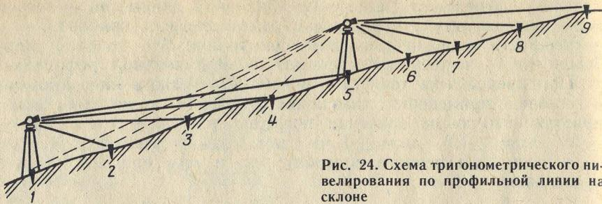
Рис. 24. Схема тригонометрического нивелирования по профильной линии на склоне
