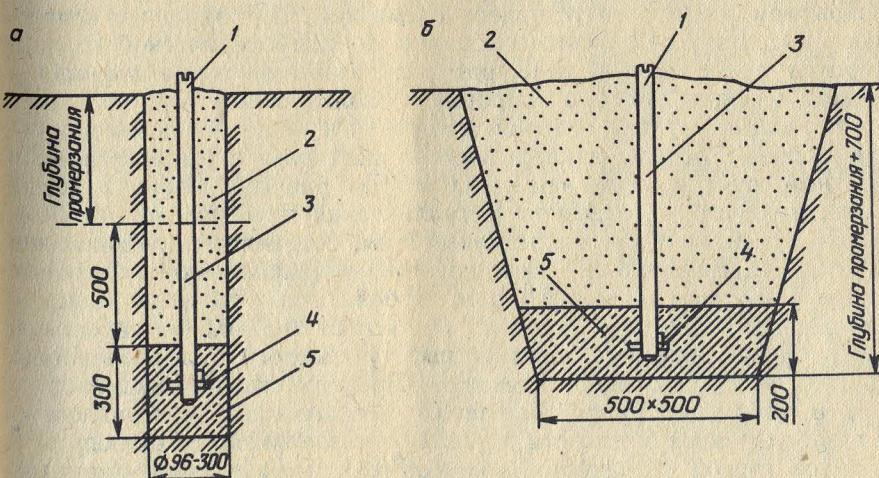
Рис. 4. Типы опорных реперов:
