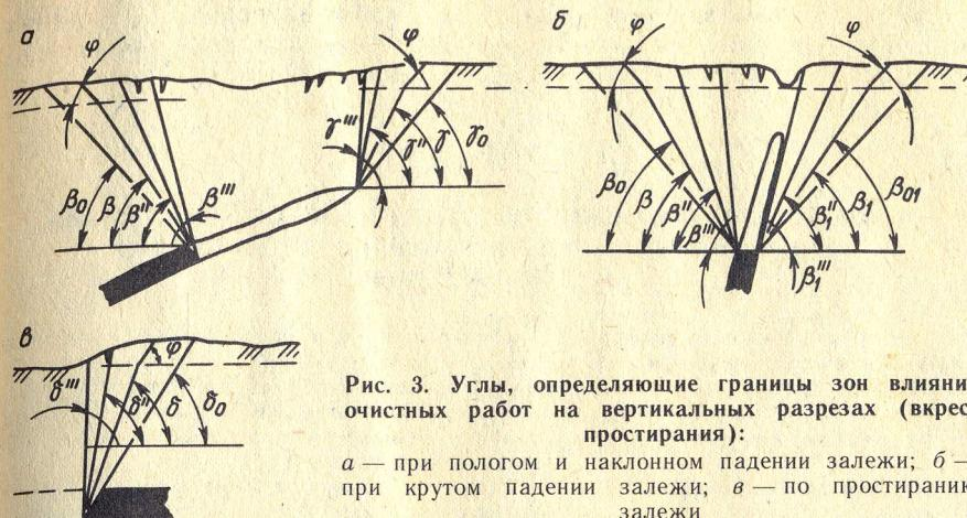
Рис. 3. Углы, определяющие границы зон влияния очистных работ на вертикальных разрезах (вкрест простириания):
