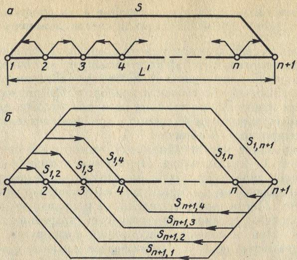
Рис. 25. Схема измерения и уравнивания длин профильных линий при использовании светодальномера
