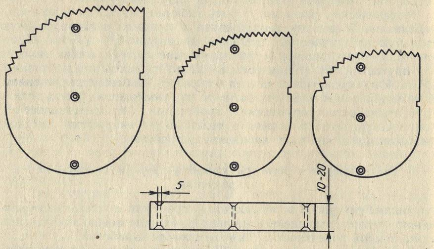
Рис. 27. Эскиз-шаблон репера (в мм):
