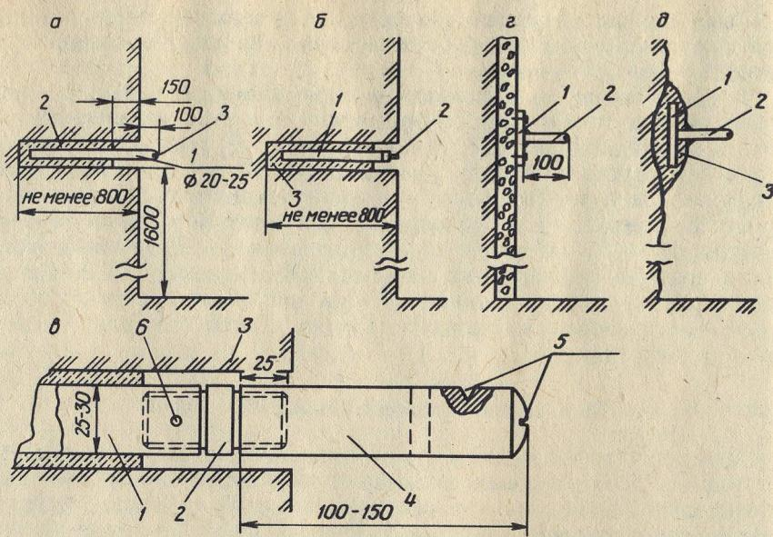
Рис. 9. Типы стенных реперов в горных выработках:
