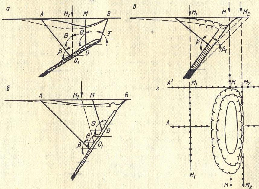
Рис. 1. Схема определения мест расположения профильных линий по простиранию залежи (на разрезе вкрест простирания залежи):
