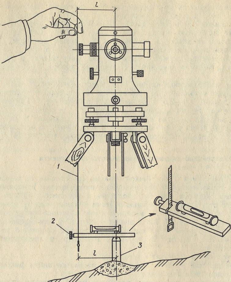
Рис. 15. Устройство для измерения высоты инструмента:
