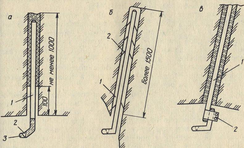
Рис. 10. Типы реперов в кровле горных выработок:
