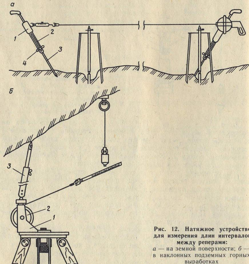
Рис. 12. Натяжное устройство для измерения длин интервалов между реперами:
