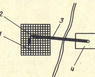
Рис. 17. Тип «маяка» для замера относительных смещений краев трещин
