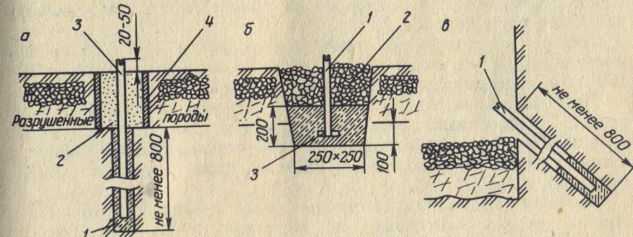
Рис. 8. Типы реперов, применяемых в почве подземных горных выработок:
