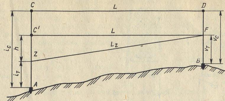
Рис. 22. Схема измерения расстояния и вертикальных углов между реперами внутри секций
